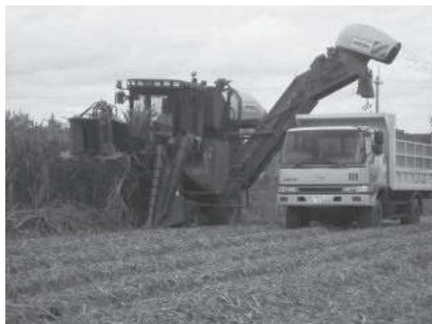
図1 ハーベスタによる収穫作業
