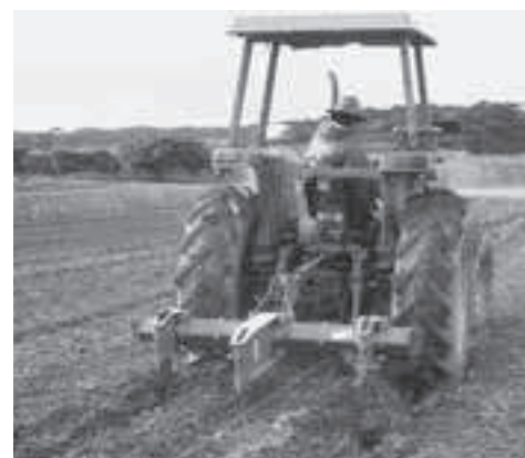
サブソイラによる耕盤破碎
