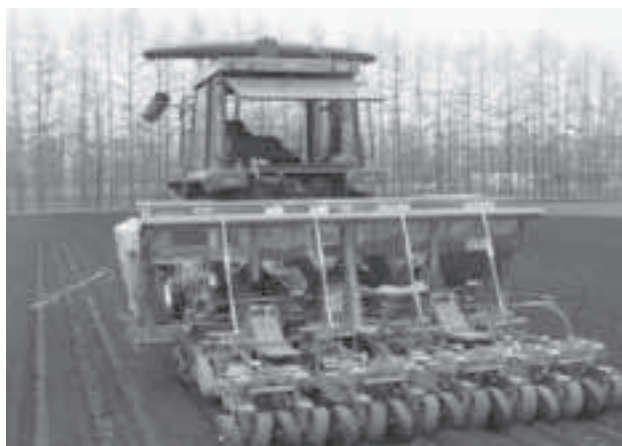
写真1 耐風害播種床形成機構を装着した開発機（耐風害仕様）
