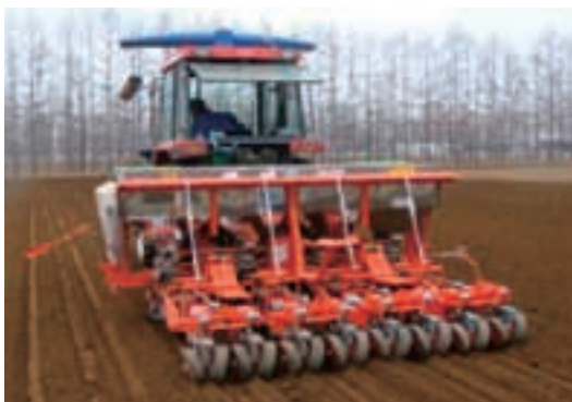
耐風害播種床形成機構を装着した開発機（51ページ参照）
