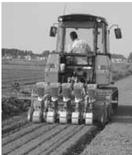
図4 ソバの耕うん同時畝立て播種作業機（耕うん幅 右：160cm、左220cm）
