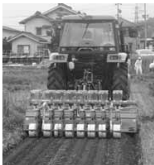
図4 ソバの耕うん同時畝立て播種作業機（耕うん幅 右：160cm、左220cm）
