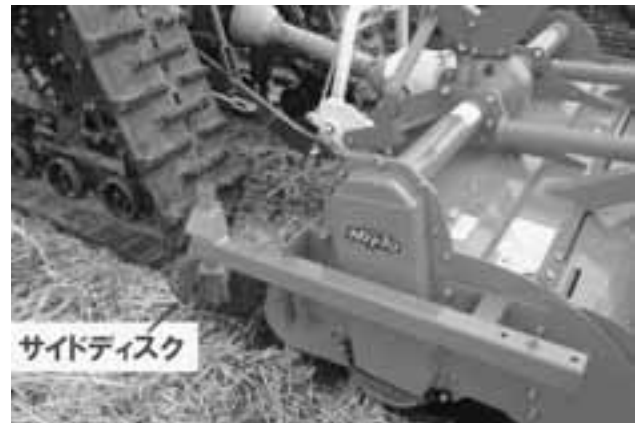
図7 ワラ絡み防止用サイドディスク
