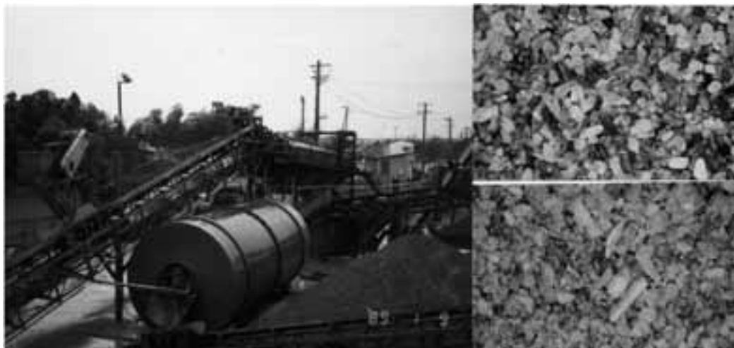
写真3 「洗い砂」処理に用いた分級機（左）と洗い砂（右上）および連作砂（右下）の拡大写真
