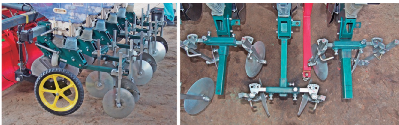
小畦立て播種装置装着図。ベース機：RXG-6PSE（アグリテクノ矢崎） 詳細は本文参照（福井県 提供）
