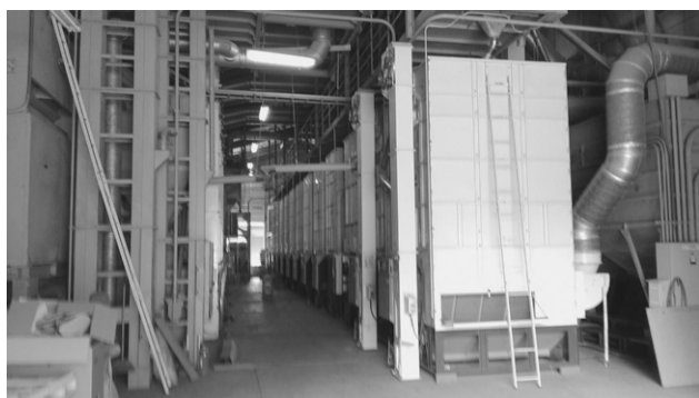
JA ライスセンターのソバ専用乾燥機
