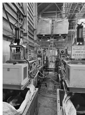
バイオコークス製造機（真横）（横型2列タイプ）
