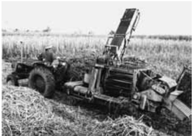
・弊社と文明農機(株)の共同開発で、「南西型ドラム脱葉機」として、昭和50年頃より各生産組合に補助事業として導入。
